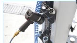
Schlagschrauberhalterung mit integrierter Ablage für Aufnahmeerhöhungen.
