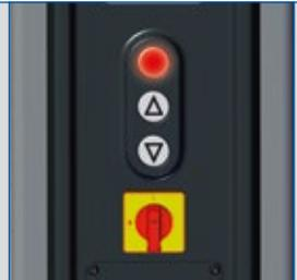
Sensorstörung. Signalleuchte blinkt rot.
