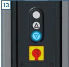
Obere Endposition oder Deckenlichtschranke erreicht. Nur Senken möglich. Senken-Taste leuchtet blau.
