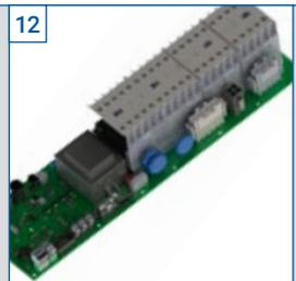
Sämtliche Sensoren und Optionen (zweite Bedieneinheit, Deckenlichtschranke) mit elektrischer Versorgung auf Platine steckbar (plug & play).
